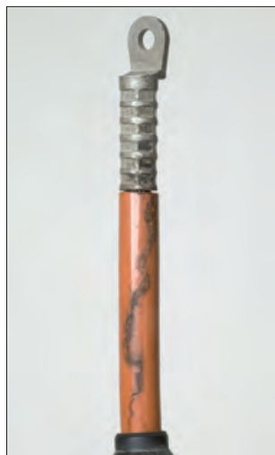
Образец, поврежденный трекинговой дорожкой
